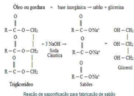
Figura 1. Reações de saponificação para fabricação de sabões. Fonte: PERUZZO e CANTO, 2007.
